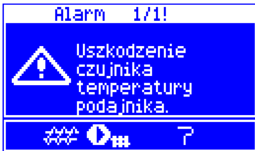
Abb. 11 Beschädigung des Förderertemperaturfühlers.
